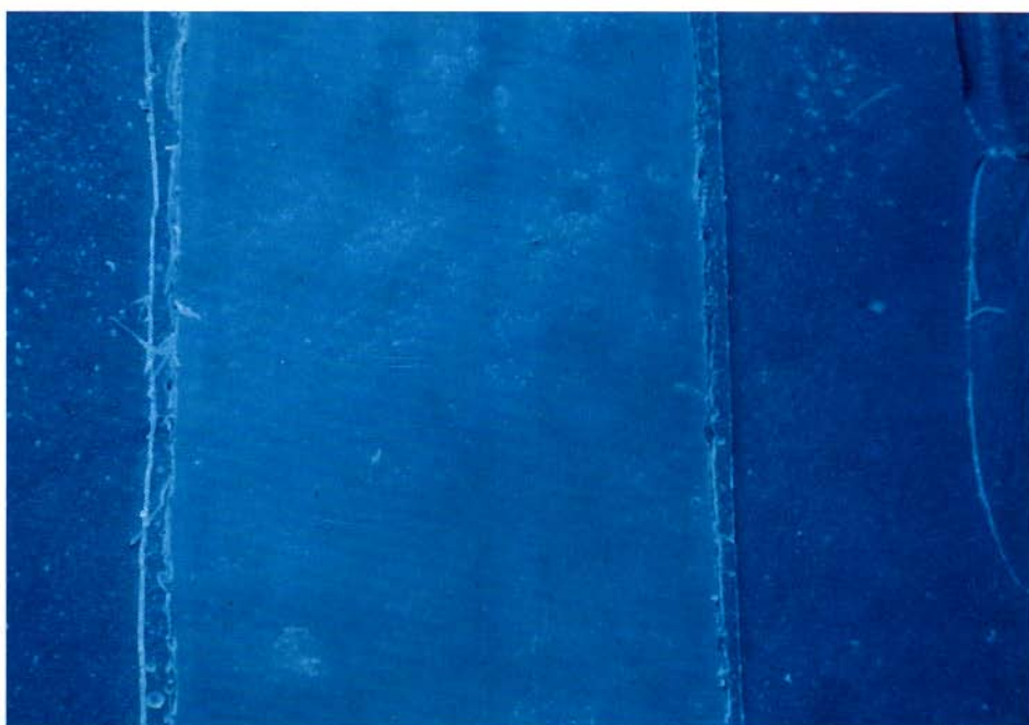
Fig.6 - Sezione di un perno-moncone fuso cementato con ossifosfato di zinco osservato al S.E.M. a 20 ingrandimenti.
